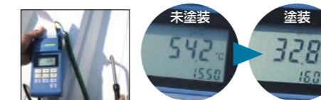
※スタースコートを塗装している工場と未塗装の工場が隣接した状態で計測
