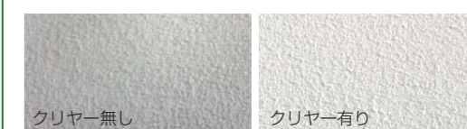
●汚れの著しく付きやすい壁面での比較試験
